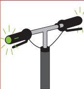
①緑色の最高速度表示灯を点滅させ 時速6km/hモードに切り換える。
