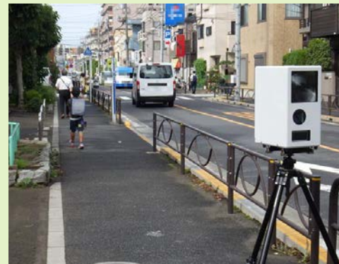
可搬式自動取締装置を活用した速度取締り
